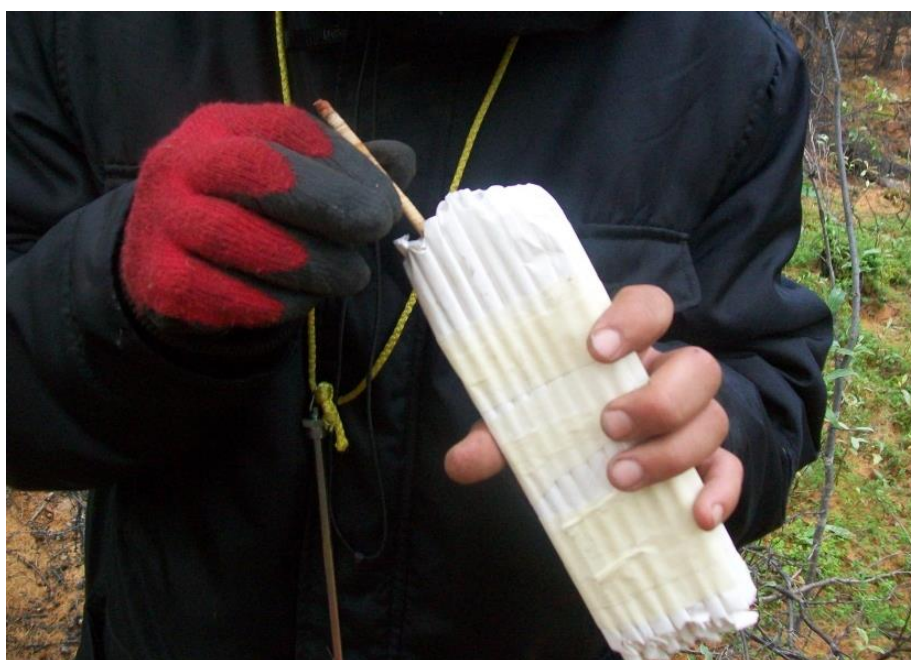
Рис. 6.3. Самодельные трубки для кернов из кальки, сложенные в кассету
