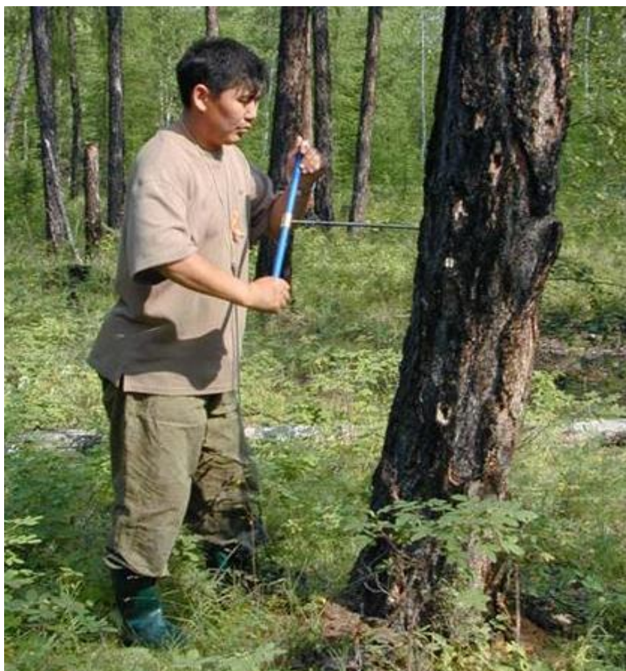
Рис. 6.2. Сбор древесного керна с помощью возрастного бурава
