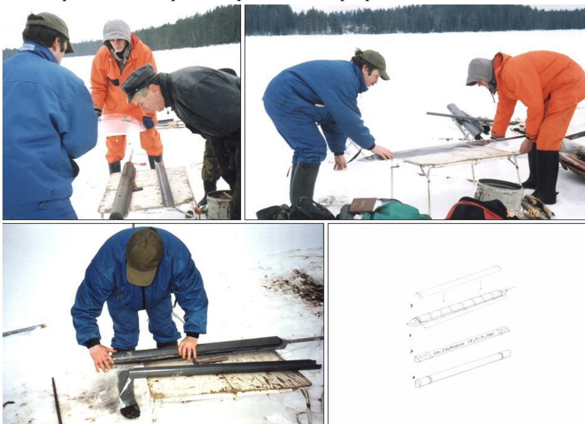
Рис. 2.2. Отбор колонок донных отложений с помощью модифицированного торфяного бура (длина рабочей части 1 м, диаметр 5, 7.5 и 10 см)
